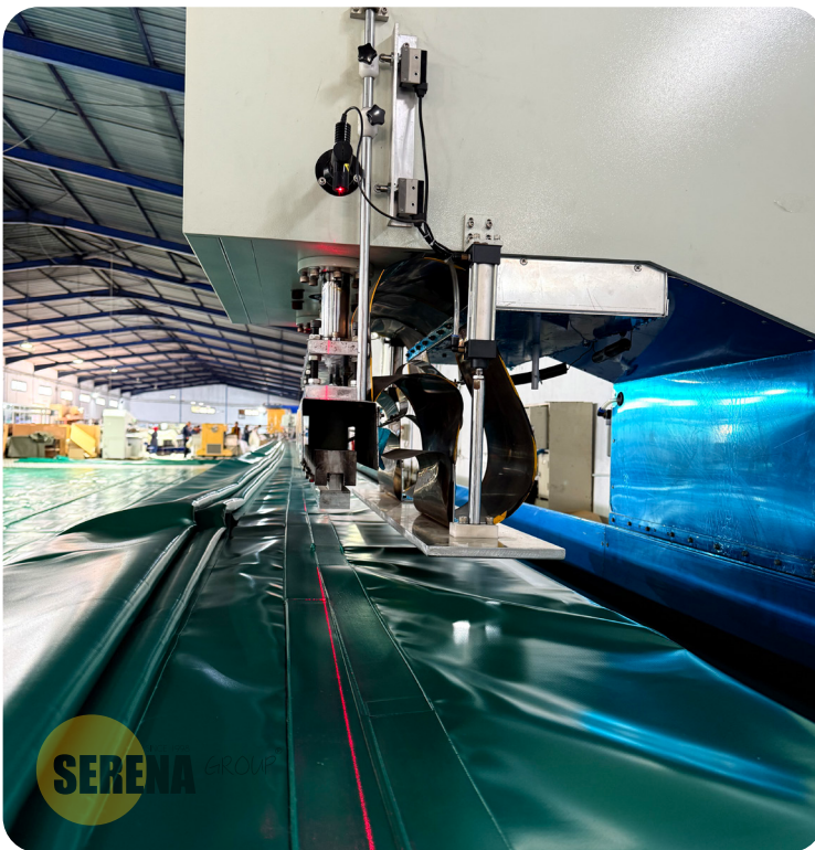
Μηχάνημα συγκόλλησης υψηλής συχνότητας σε τραπέζι μήκους 30 μέτρων
